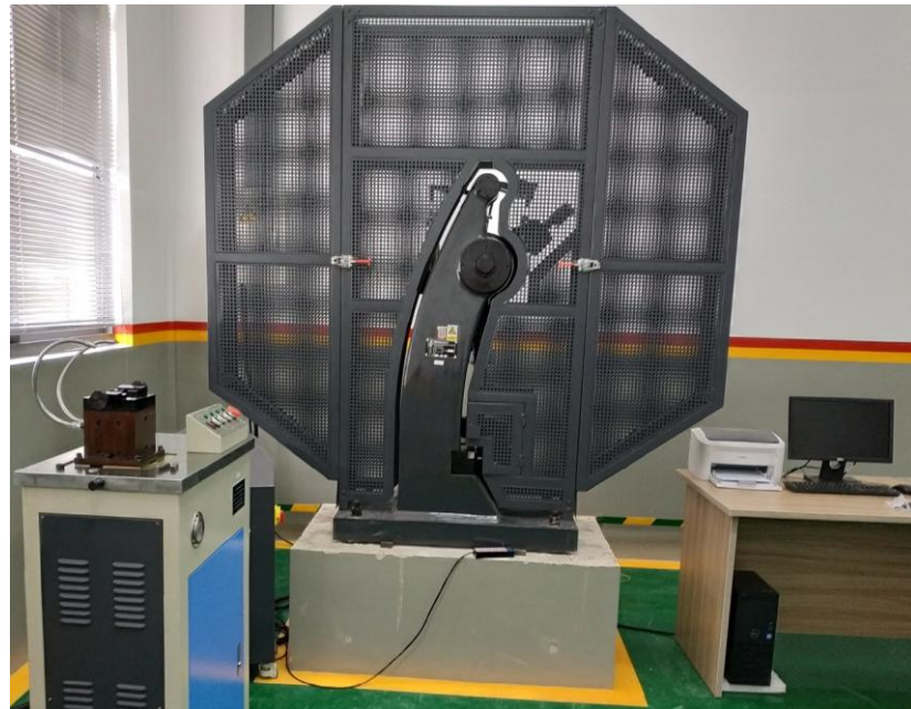
Рисунок 2.14 – Випробувальна машина для сталей марки NI300 для визначення ударної в'язкості
