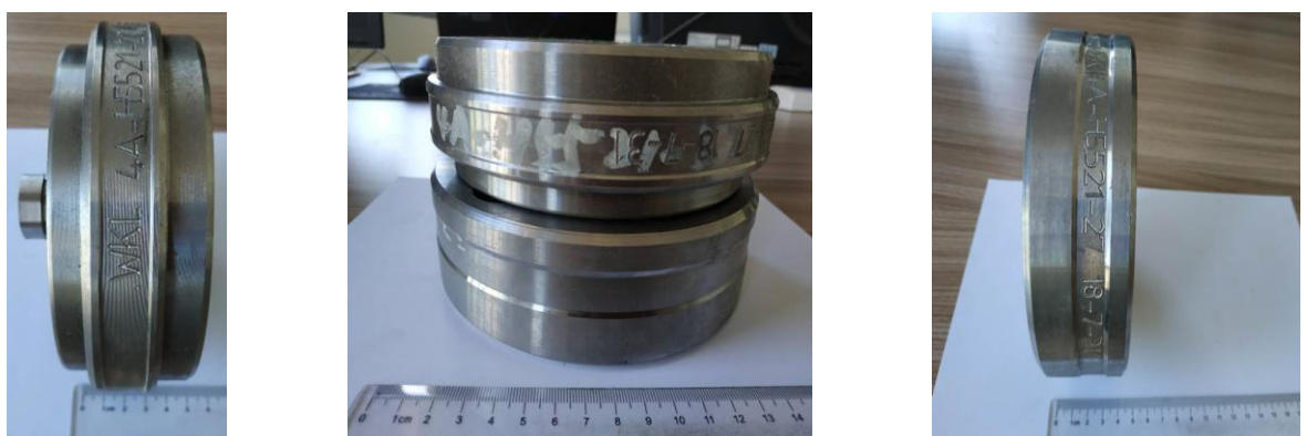
Рисунок 6.16 – Матриці із штампової литої сталі 4Х4Н5М4Ф2 для гарячого деформування алюмінієвого сплаву марки АК7ч
