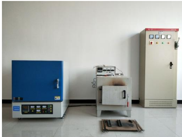
Рисунок 2.15 – Електричні печі для проведення термічної обробки сталі, що проводилась в Центрі Ningbo IPMS research and technology center Co., Ltd. (Ninghai city, Ningbo province, China)
