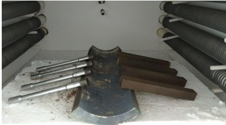
Рисунок 2.12 – Розміщення у термічній печі зразків для проведення випробувань на механічні властивості сталі (з лівої сторони – на розтяг, з правої – на ударну в’язкість)
