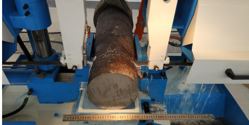
Рисунок 4.3 – Механічна обробка заготовок (сталь 4X4H5M4Ф2), одержаних за ЕШКЛ, компанія «Futes Co., Ltd» м. Нінхай, провінція Чжецзян, КНР
