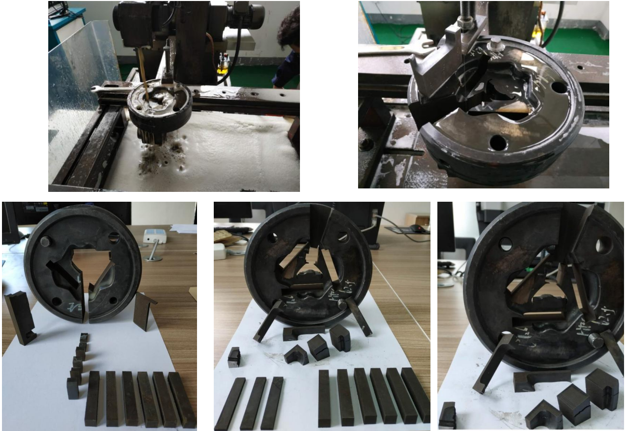
Рисунок 6. 17 – Матриці із штампових сталей марок 4Х5МФ1С (кована та азотована) та литої 4Х4Н5М4Ф2 (досліджуваної) після їх експлуатації
