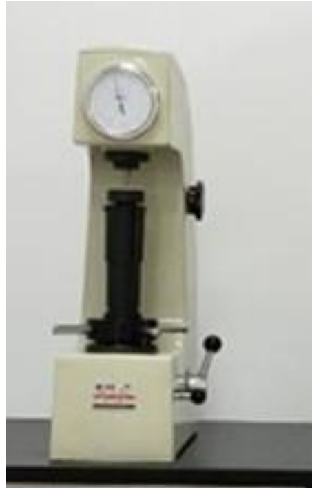
Рисунок 2.13 – Твердомір HR–150А для визначення твердості сталі за кімнатної температури
