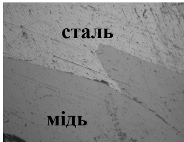
Рисунок 6.6 – Макроструктури деформованої сталі 4X5MФ1С після пресування міді марки М1. Розмір робочого отвору матриці 100x6 мм. Матриці використовували на виробництві Changzhou riye machine Co., Ltd, Chine. а – без травлення, x100; б, в, – травлення 10 % HNO 3 ; б – x200; в – x100
