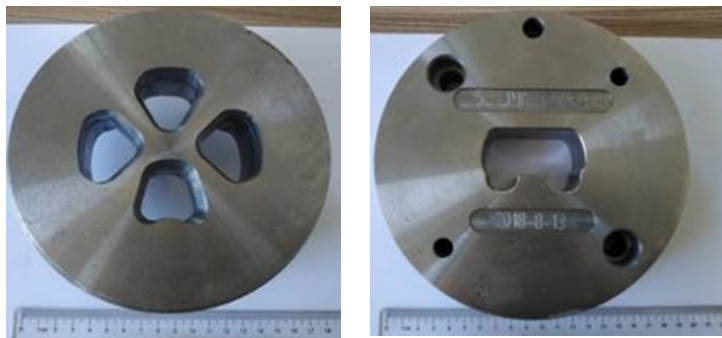
Рис.33. Матриці із литої сталі 4X4H5M4Ф2 для гарячого деформування алюмінієвого сплаву марки АК7ч в корпорації New material technology Co., Ltd.» (м. Куньшань, провінція Цзянсу, КНР)
