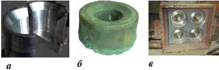
Рис.1. Одержання литої сталі 4ХЗН5М3Ф: а – розбірний кокіль для отримання зливків лігатури системи Fe–Ni–Mo–V–Mn; б – зливкок (маса 15 кг);
