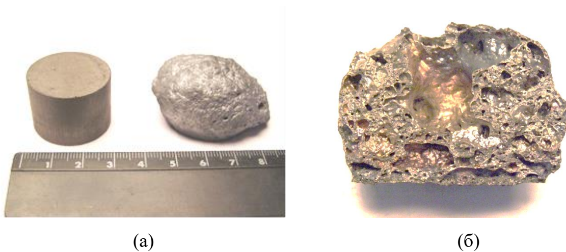
Рисунок 2.6- Типовий вигляд зразків до і після спікання (а) та поверхня зламу синтезованого матеріалу системи (Fe-Ni)-(Ti-C) (б).
