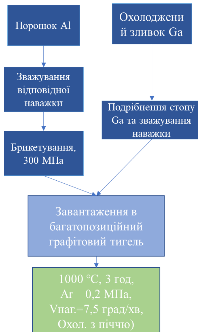
Рисунок 2.2 – Технологічна схема отримання зразків матеріалів системи Al-Ga
