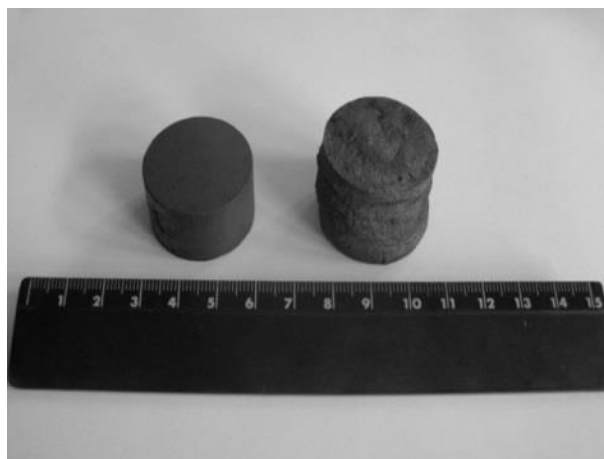
Рисунок 2.4 - Зовнішній вигляд брикетів з модельного сплаву до спікання (ліворуч) та після спікання при 1200°C (праворуч)
