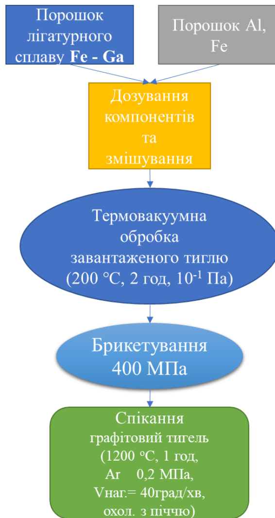
Рисунок 2.3- Технологічна схема отримання зразків матеріалів Fe-Ga-Al
