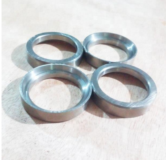
Рисунок 5.8 – Експериментальні зразки сідел клапанів насосів НМШ 5/25-2,5/6 із полікомпонентного сплаву TiCrFeNiC
