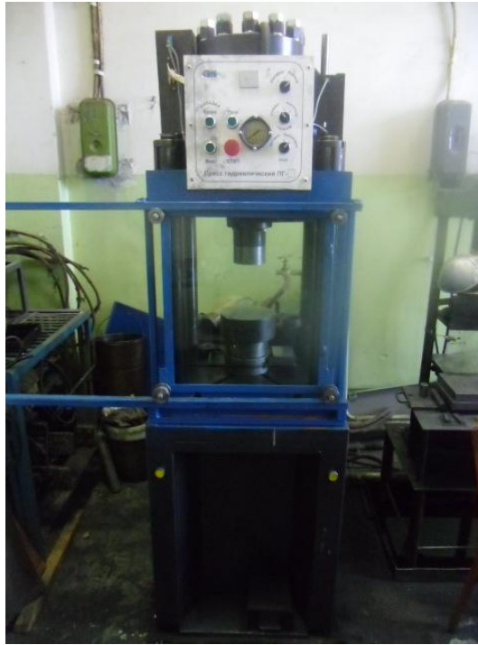
Рисунок 2.5 – Гідравлічний прес для пресування порошкових сумішей
