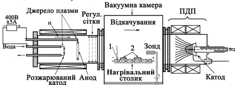
Рис.6 Схема модернізованої установки ННВ-6,6 типу «Булат», оснащеної джерелом плазми
